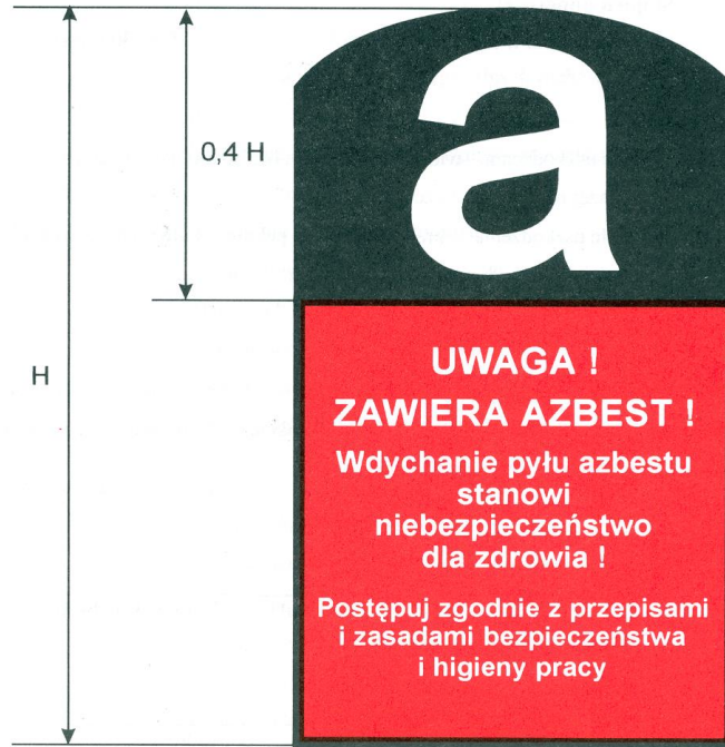
Rys.2. Wzór etykiety do oznakowania wyrobów i odpadów zawierających azbest, zgodnie z załącznikiem do Rozporządzenia Ministra Gospodarki, Pracy i Polityki Społecznej z dnia 2 kwietnia 2004 r. w sprawie sposobów i warunków bezpiecznego użytkowania i usuwania wyrobów zawierających azbest.
